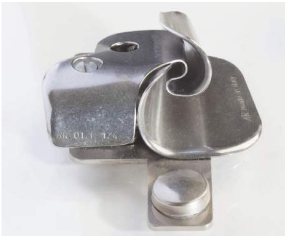
Ribattitore utilizzato nella bordatura dei jeans
