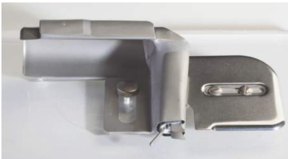
Bordatore utilizzato nella bordatura dei jeans
